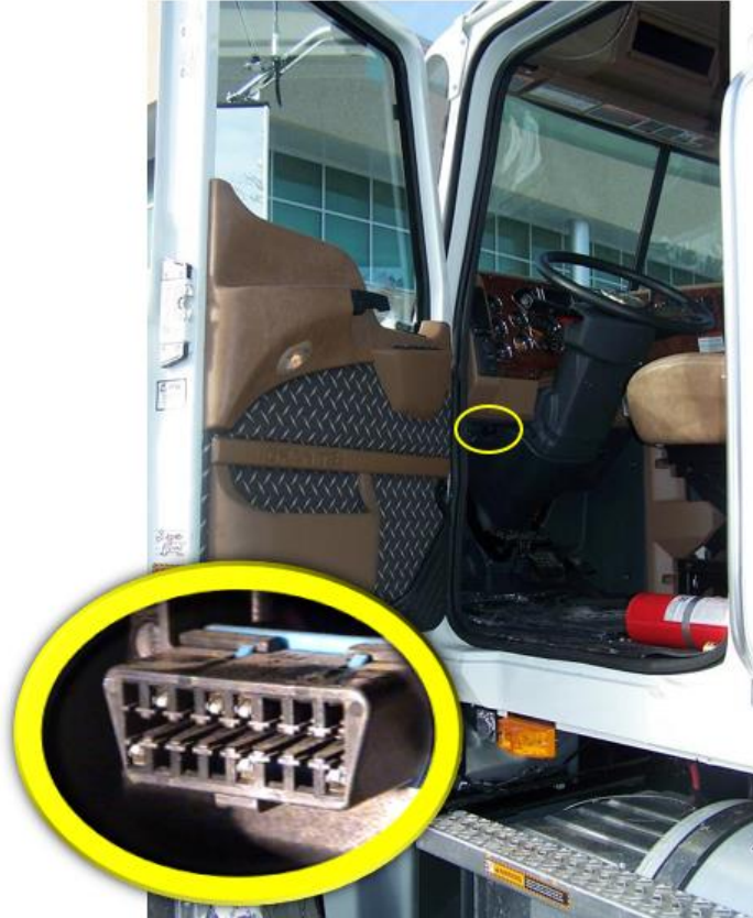
Figure 3.0.5. Camion-tracteur Mack de modèle récent avec CLD de type OBD-II
