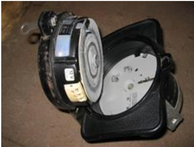
Figure 3.1.31. Tachygraphe mécanique avec disque papier visible
