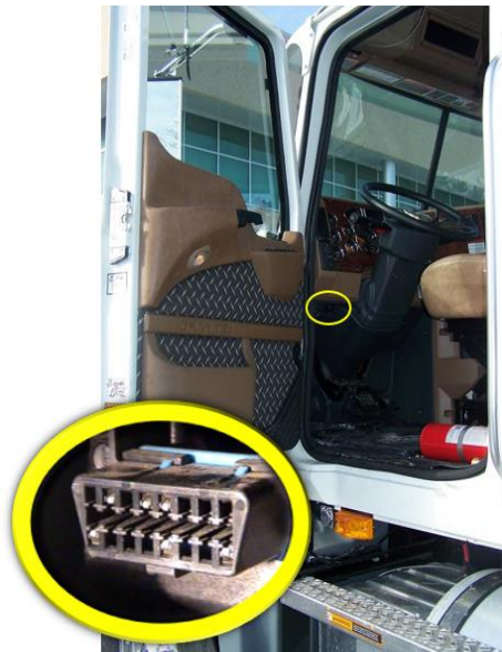
Figure 3.1-3. Camion-tracteur Mack de modèle récent avec CLD de type OBD-II
