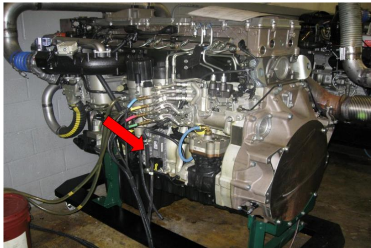
Figure 3.1.1.1-2. Emplacement typique du MCM VI/10/13/16 de la DDEC
