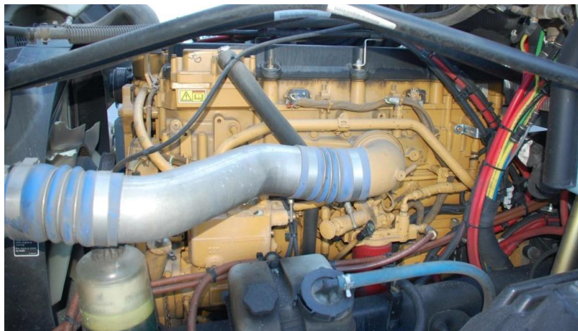
Figure 3.1.3-1. Emplacement typique de l'UCE d'un moteur Caterpillar
