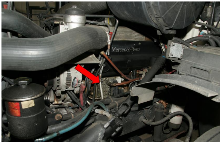
Figure 3.1.1.2-1. Emplacement typique d'une PLD du MMB
