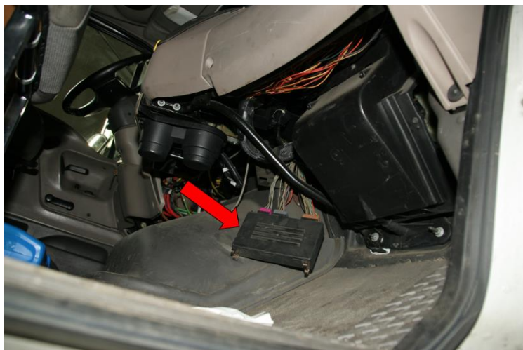
Figure 3.1.1.2-2. Emplacement typique d'une UCV du MMB
