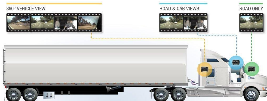
Figure 3.3.1-2. Configuration de la caméra SmartDrive 35
